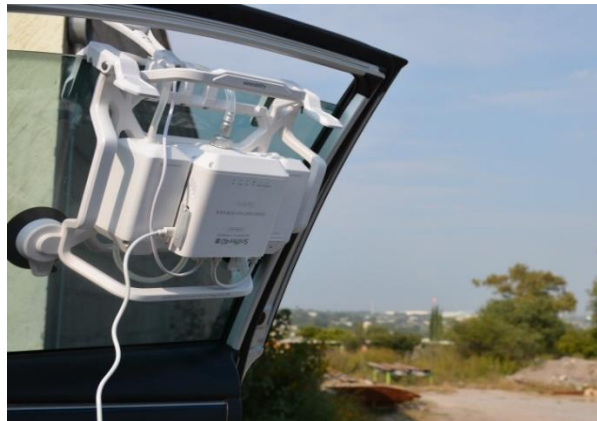
Imagen 2. Sniffer montado en vehículo
