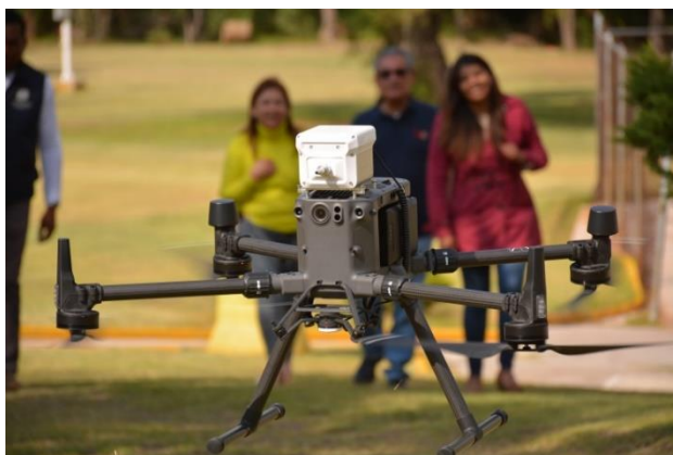
Imagen 3. Sniffer montado en drone Matrice 300
